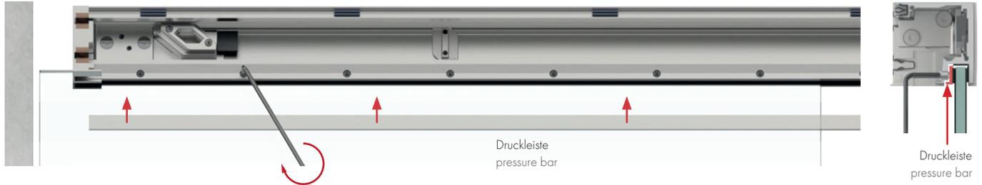
Die Laufschiene wird mechanisch auf dem Seitenteil fixiert, eine Verklebung ist nicht erforderlich.
